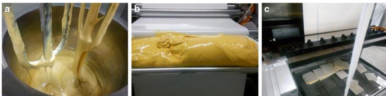
Рисунок 4 – Процесс изготовления гидрогелевых пластырей методом каландрирования: смешивание (а), нанесение покрытия (б) и отрезание (с) [15]
